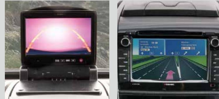
Optional für die Rückfahrkamera: klappbarer Monitor oder Empfang über das Navigationsgerät
