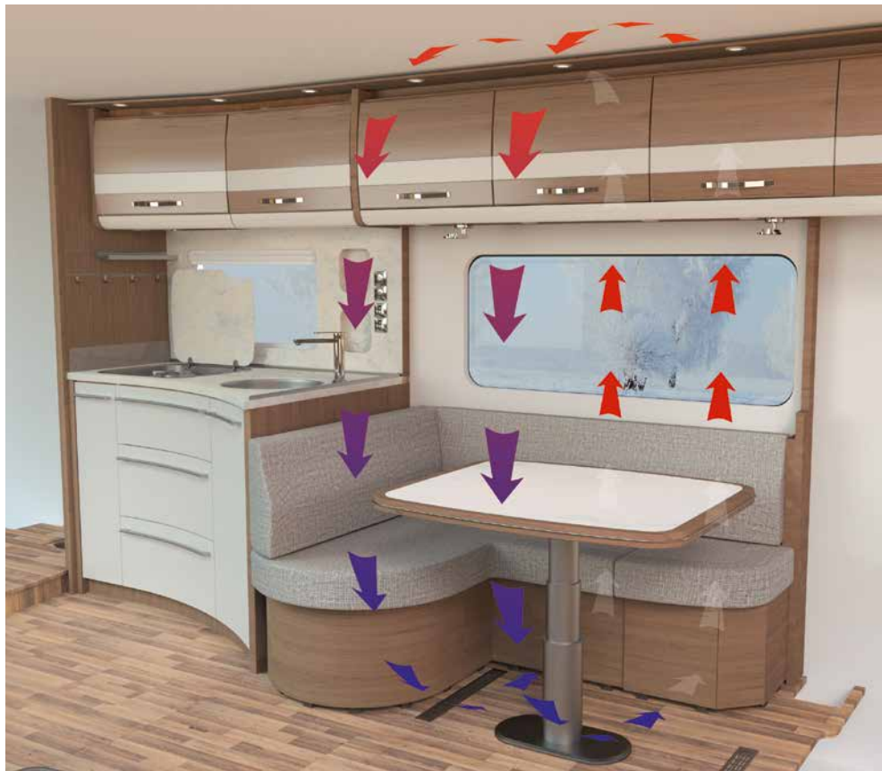
AirPlus hinterlüftet die Dachschränke und verhindert so die Bildung von Kondenswasser
