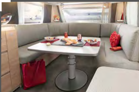
Großzügige Beinfreiheit bietet der höhenverstellbare Einsäulen-Hubtisch
