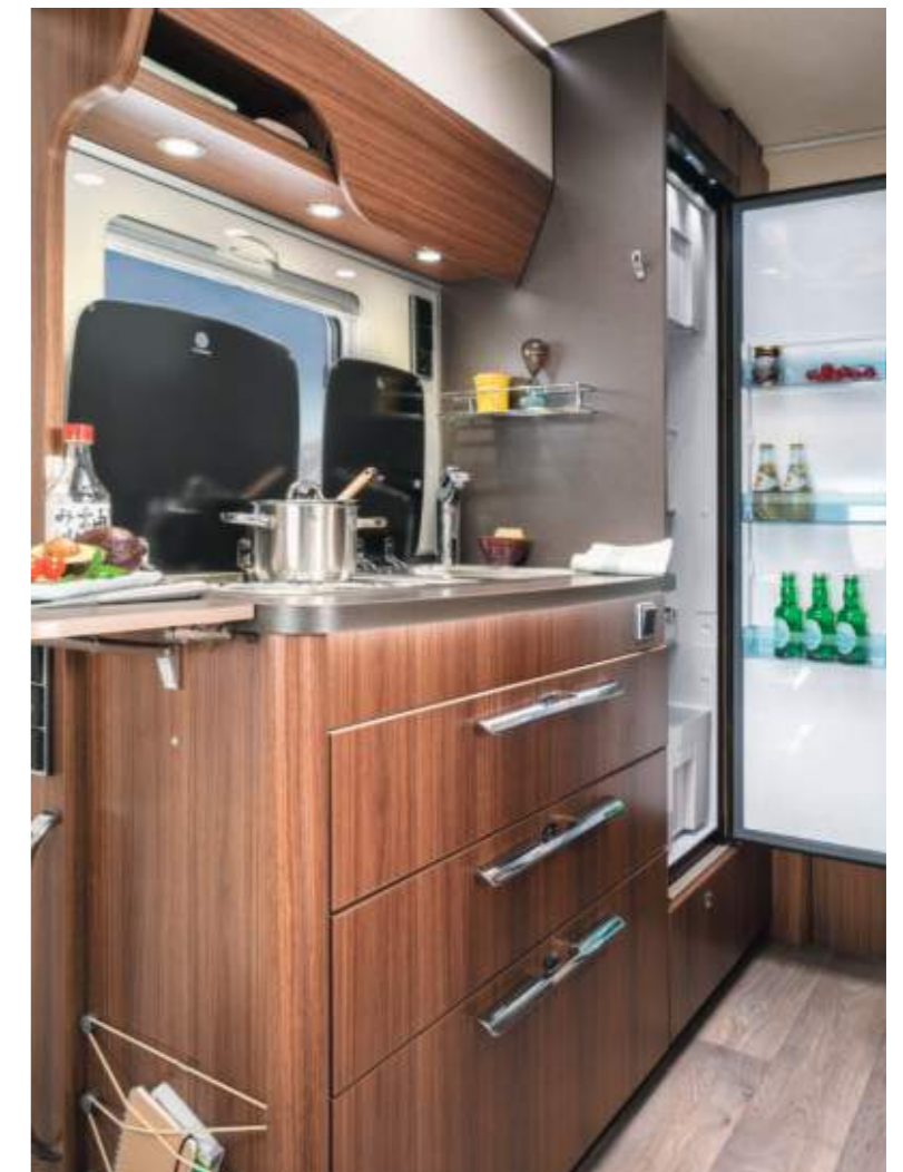
Moderne Seitenküche. Ein Smart-Tower-Kühlschrank (142 Liter), eine ausklappbare Arbeitsplattenerweiterung sowie auf Wunsch eine Küchenwandverkleidung mit vielen Zusatzsteckdosen im ganzen Fahrzeug. Die frei einteilbaren Küchenschubladen in verschiedenen Größen und die bequem zu erreichenden Dachstauschränke – all das bietet die große Seitenküche des ML-T 580, hier im Möbeldekor Noce Cognac.
