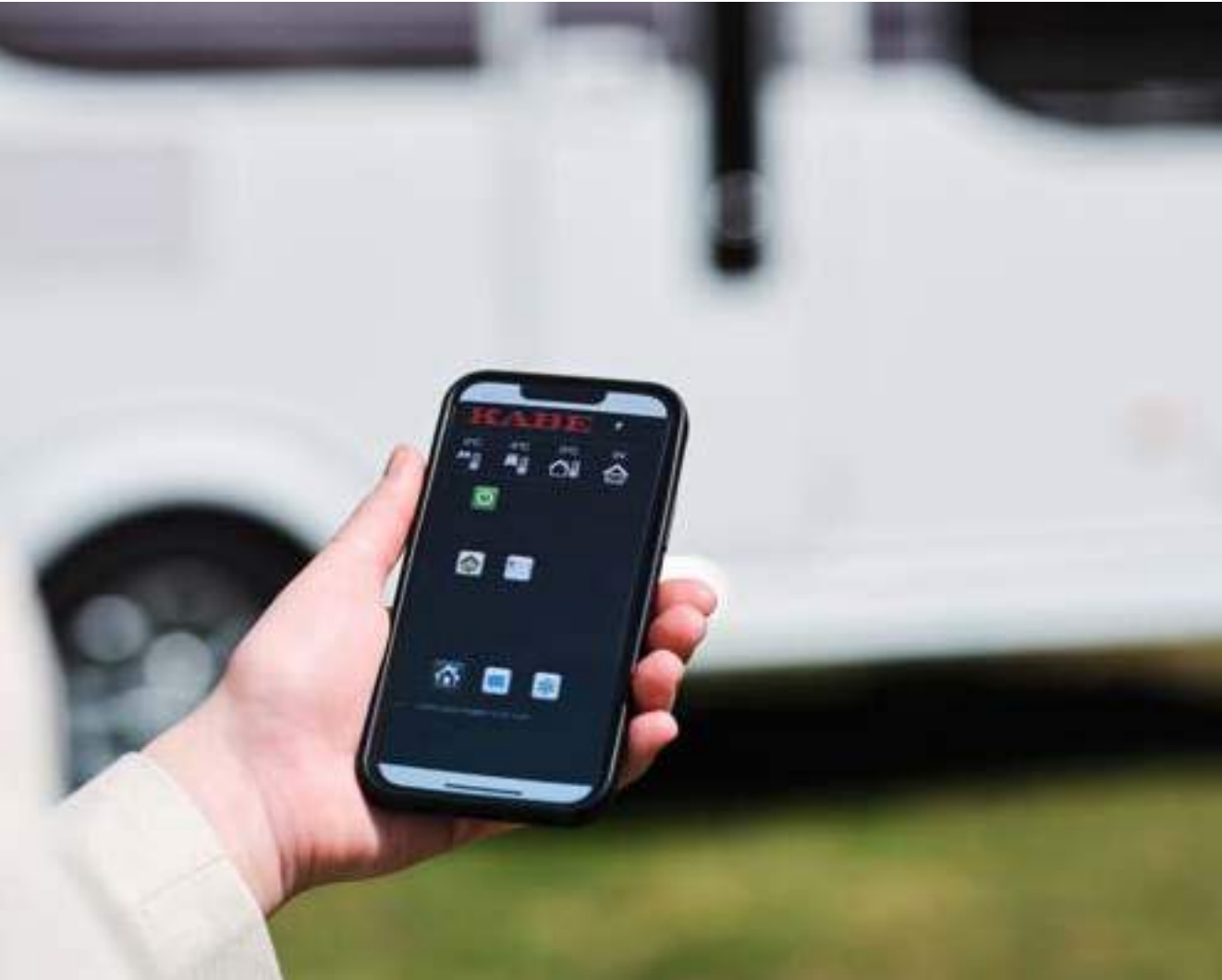
KABE Smart D Remote. Mit KABE Smart D Remote* können Sie die Bedientafel Ihres Wohnwagens von jedem beliebigem Ort aus über eine App steuern. KABE Smart D Remote basiert auf einem 4G-Router mit internen Antennen (externe Antenne als Zubehör erhältlich). Damit können Sie nicht nur die Heizung und die Beleuchtung steuern, sondern auch weitere Funktionen und Alarmmeldungen des Wohnwagens über das Handy kontrollieren. Zudem haben Sie auch unterwegs Zugriff auf eine gute, drahtlose Internetverbindung.
